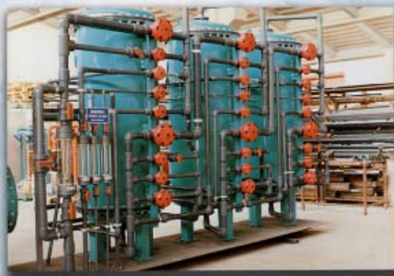
IMPIANTO DI DEMINERALIZZAZIONE DEMINERALIZATION PLANT
