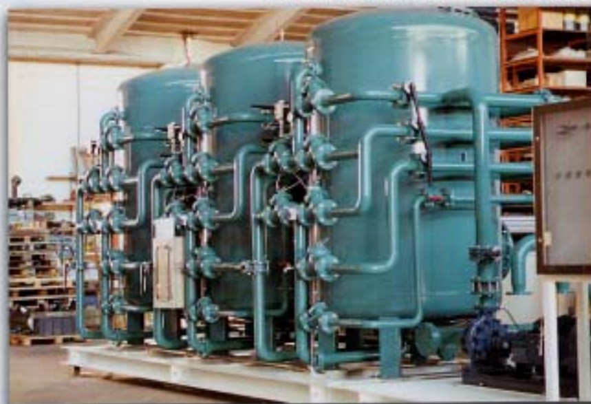
IMPIANTO DI FILTRAZIONE MULTIMEDIA WF 8/A MULTIMEDIA SAND FILTRATION PLANT WF8/A
