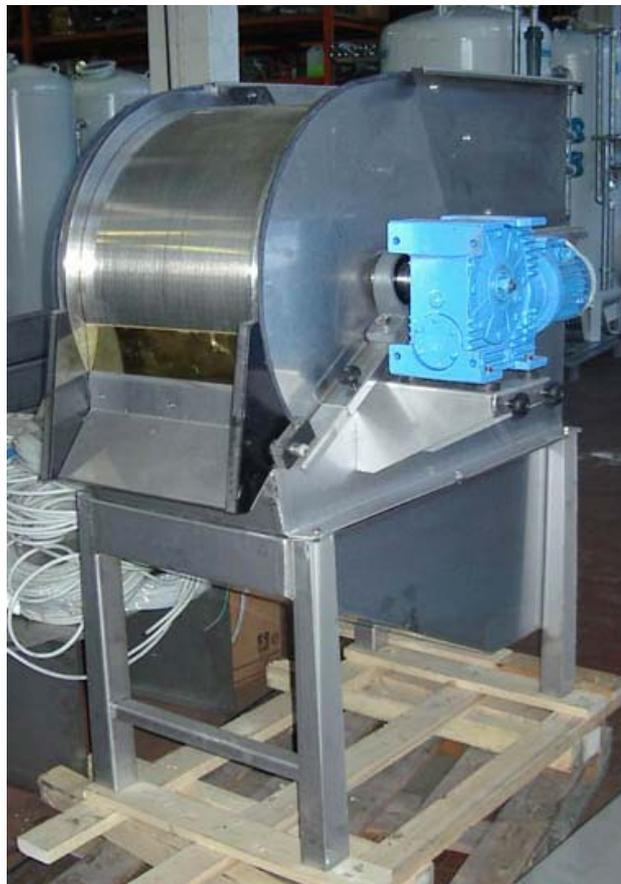
Filtro a tamburo fino a 20 m<sup>3</sup>/h installato in area MANUTENCOOP SpA- Villanova di Castenaso
