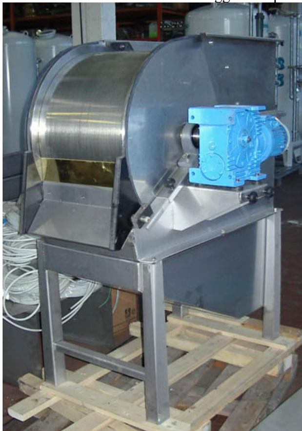
Filtro a tamburo da 20 m<sup>3</sup>/h installato in area lavaggio compattatori a Villanova di Castenaso (BO)
